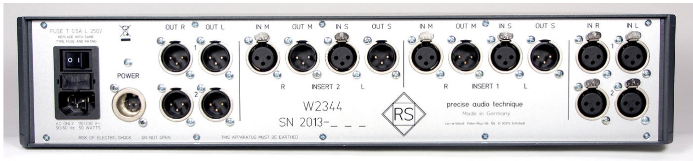
Die Kaltgeräte-Netzbuchse ist dem Prototypen-Status geschuldet und wird beim künftigen Seriengerät nicht vorhanden sein.
