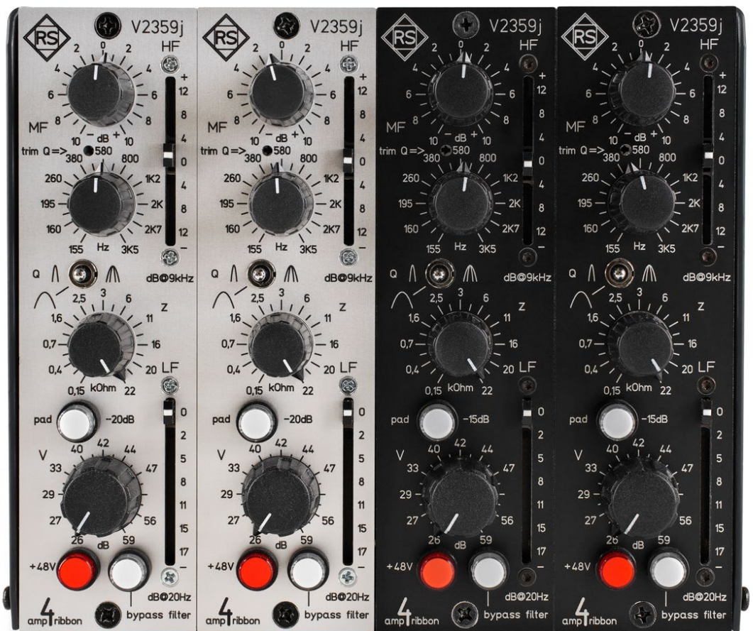
Der V2359j amp4ribbon ist ein Mikrofonvorverstärker im 500 API-Modul-Format für die universelle Anpassung passiver Schallwandler, vorzugsweise Bändchenmikrofonen. Er wird von Entwickler Roger Schult von Hand gebaut und ist mit silberner und schwarzer Front erhältlich. Das „j“ im Namen steht für „Junior“. Eine 19 Zoll-Variante ist für 2023 zu erwarten.
