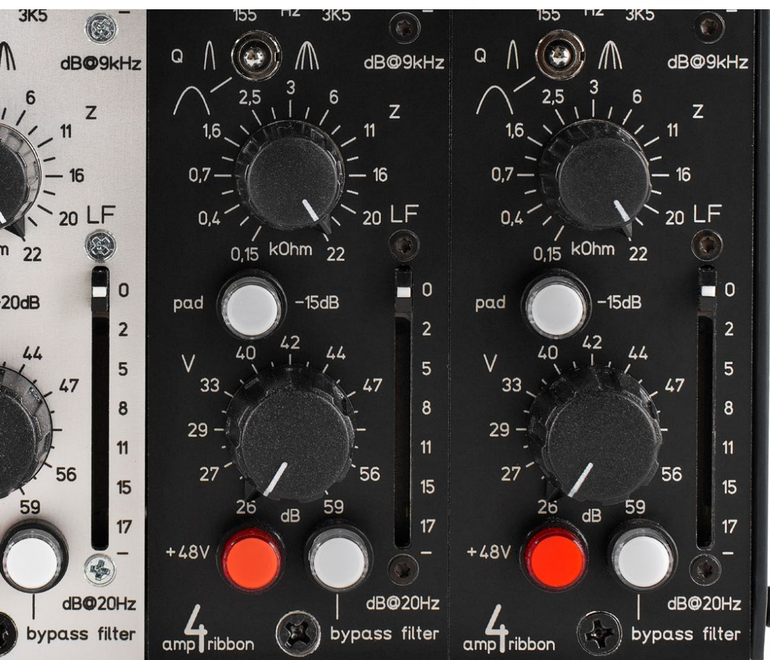
Die Verstärkung lässt sich stufenlos im Bereich von 26 bis 59 dB einstellen, optional via Jumper-Setting bis maximal 76 dB erhöhen. Das Hochpassfilter dient der Reduktion tieffrequenter Störungen und setzt bei 20 Hertz ein. Über dem Gainregler ist der Regler für die stufenlose Einstellung der Eingangsimpedanz im weiten Bereich von 150 Ohm bis 22 Kilohm – ein mächtiges Werkzeug zur Klangformung.
