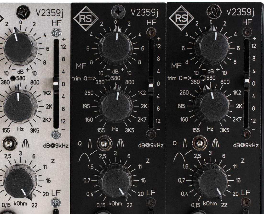
Mit dem halbparametrischen Mittenfilter – in der Mitte zu sehen – ist die Betonung der Charakteristik des angeschlossenen Mikrofons möglich. Für den Hochtonbereich gibt es einen Baxandall-Klangsteller, der bei neun Kilohertz ansetzt. Ein aus der Praxis für die Praxis entwickelte Lösung. Beide Filter lassen sich auch nachträglich beim Mischen gewinnbringend einsetzen.
