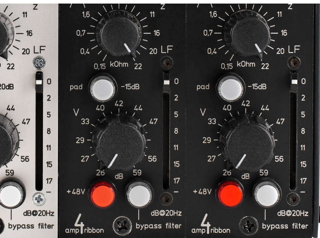
„+48 V“-„Bypass Filter“- und „Pad“-Drucktaster sind hinterleuchtet. Die Intensität der LEDs lässt sich über Jumper-Settings einstellen.
